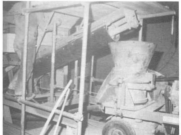
Abb.8. Beschickung durch eine Förderschnecke.
