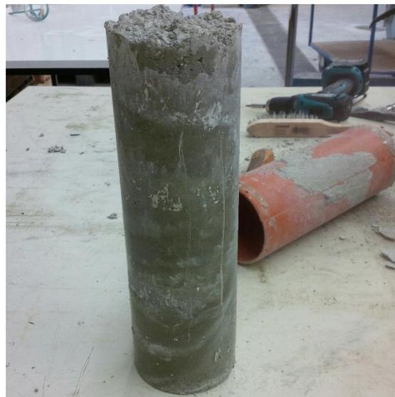
*Bild 11: Schalung zur Herstellung von jungen Spritzbetonversuchskörpern im Vortrieb (links) und ausgeschalteter Spritzbetonversuchskörper (rechts) [Quelle M. Neuner]*
