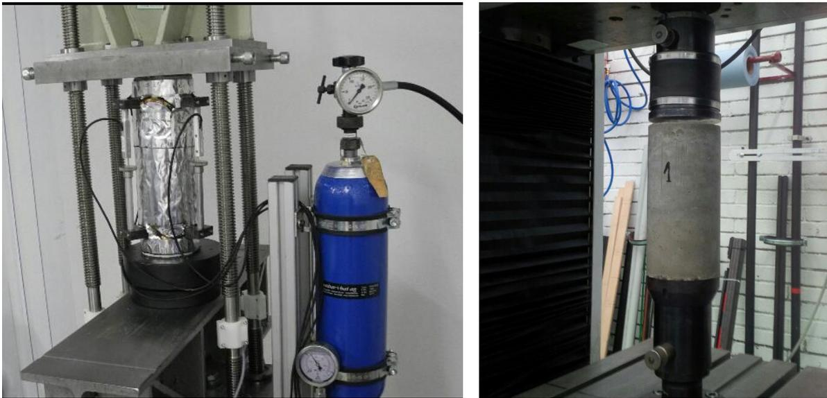
*Bild 12: Kriechversuch am 8h, 24h und 27h alten Spritzbeton, versiegelt mit Aluminiumfolie und Bitumen gegen Austrocknung (links) und Druckfestigkeit (rechts) [Quelle M. Neuner]*
