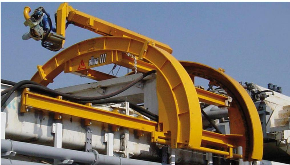
*Bild 3: Spritzbetonmanipulator auf elliptischem Bogen, Fa. Sika – Aliva, [6]*
