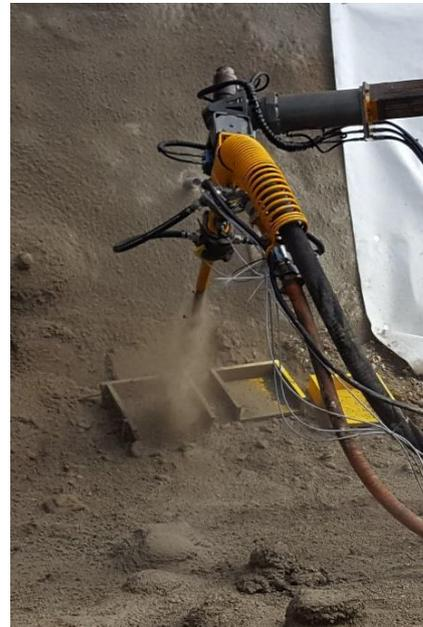
*Bild 6: Filmen des Spritzstrahls mit Hochgeschwindigkeitskamera und Spritzen von Kisten*
