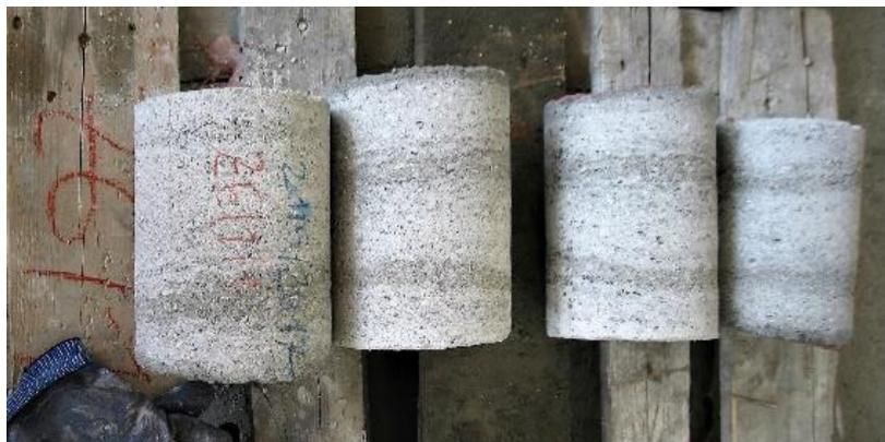
*Bild 13: Unerwünschte Lagigkeit von Bohrkernen, die an oberflächlich trockenen, im Inneren bzw. in den Fehlstellen noch feuchten Proben sichtbar wird.*
