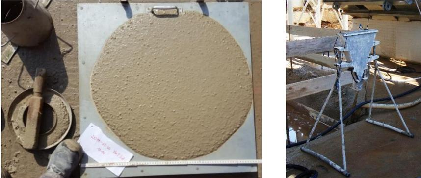
Bild 2: Ausbreitmaß von Nassmischgut und Messgerät für die Prüfung der Trichterauslaufzeit
